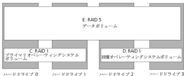
図 3-1 ソフトウェア RAID デフォルトハードドライブのパーティション
